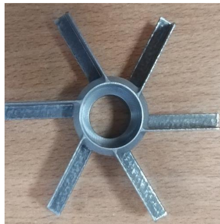
Pièce réalisée via technologie lit de poudre
