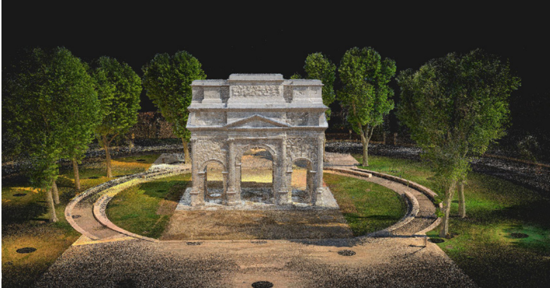
Nuage de points du relevé de l'Arc de Triomphe d'Orange. Doc AGP
