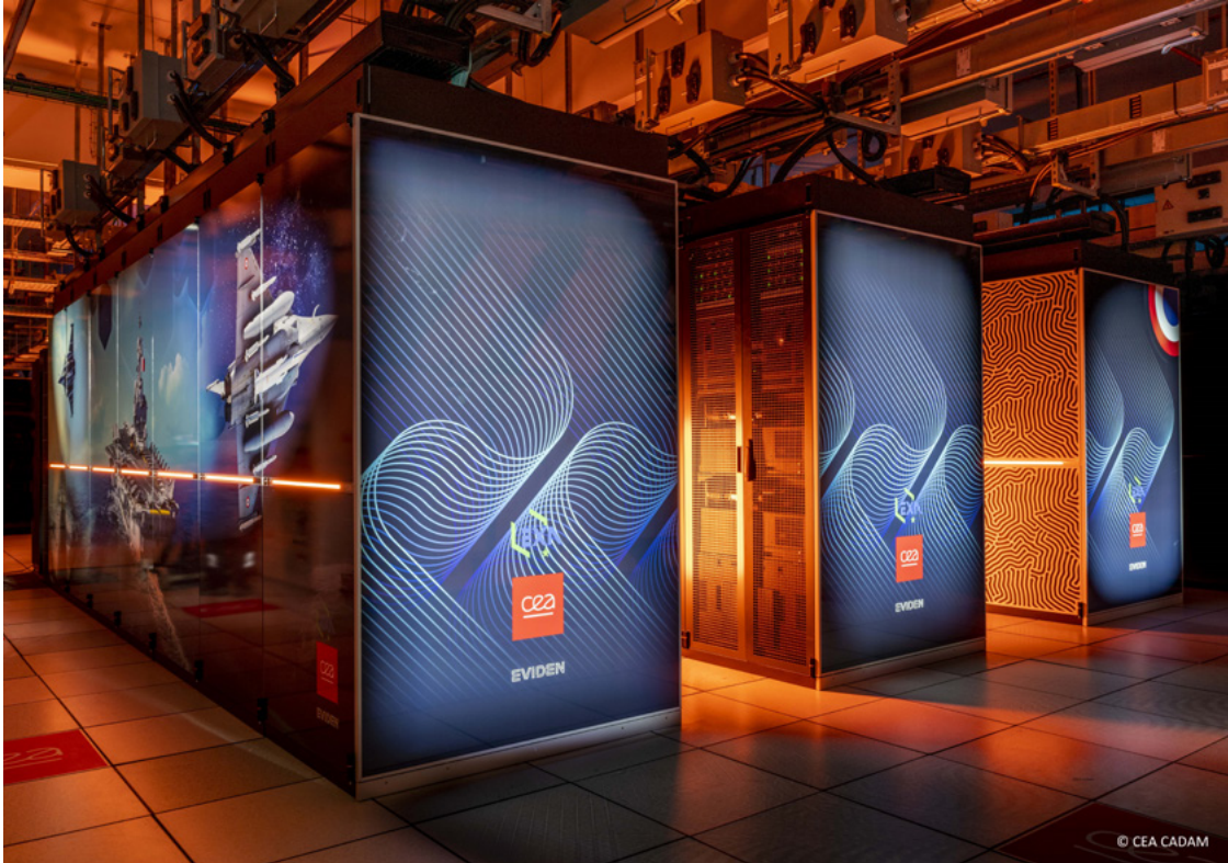
Supercalculateur EXA-HE, CEA/DAM – 180 Pflop/s BullSequana XH3000, avec processeurs Grace Hopper Superchip 72C 3GHz, NVIDIA GH200 Superchip BullSequana eXascale Interconnect (Quad-Rail BXI v2) Refroidissement liquide à l'eau tiède
